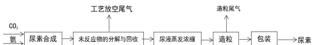
图 25-5 尿素生产工艺流程图
